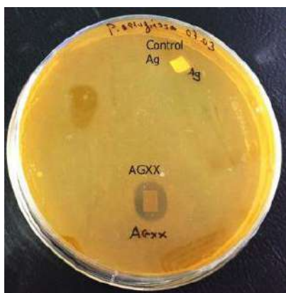
Figura 1. Halo de inhibición ocasionado por el material antimicrobiano AGXX en un cultivo de P. aeruginosa 50071 en medio BHI, en comparación con el control (Ag).
