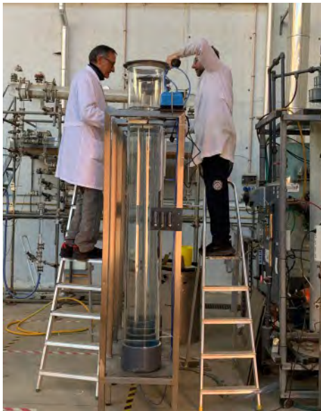
Juan y Gregorio construyendo biorreactores para cultivar microalgas
