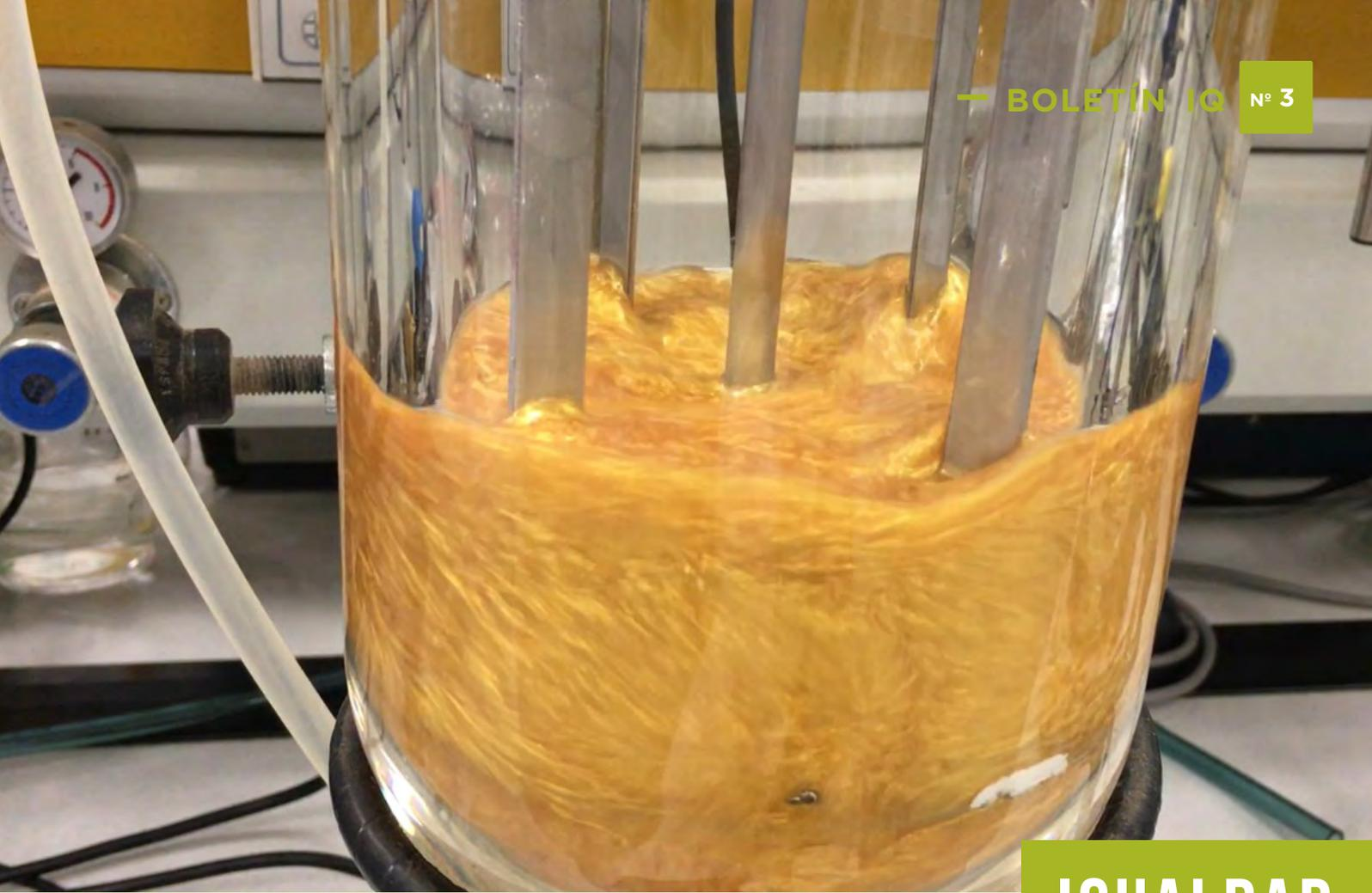
Fotografía: Reactor con tabiques deflectores agitado con varilla helicoidal.
