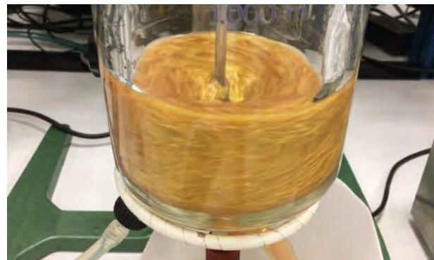
Reactor agitado con varilla helicoidal
