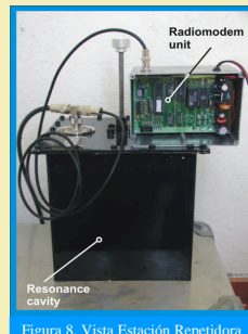
Figura 8. Vista Estación Repetidora
