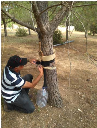
Fig. 1. Pluviómetro de cuantificación de la precipitación (P), precipitación interna (PI) y colector de agua al tronco (Et) en Pinus halepensis .
