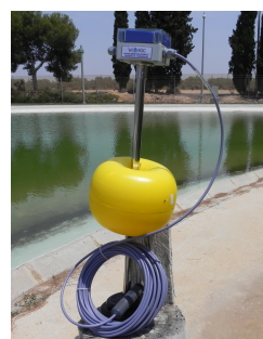
Fig. 1. (a) Electrónica de la boya. (b) Imagen de la boya antes de instalación.
